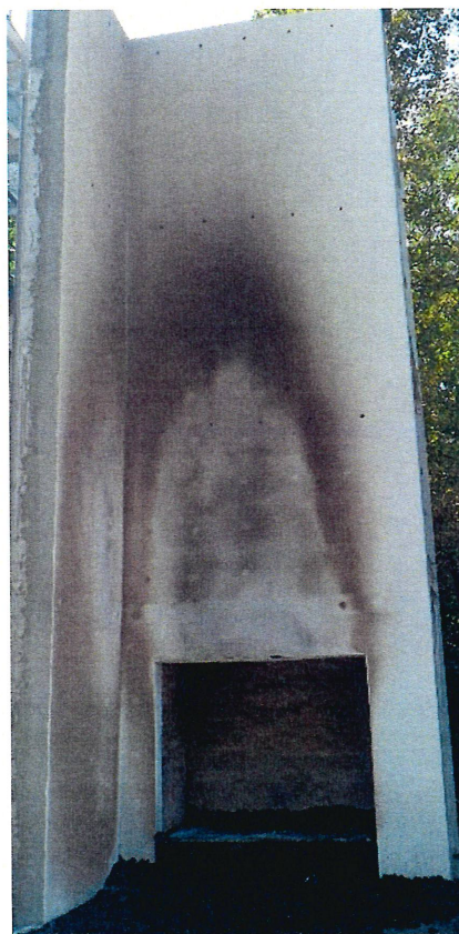
Fotografia 37. System w trakcie badania – po wygaszeniu źródła ognia
