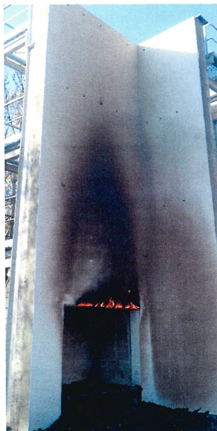
Fotografia 35. System w trakcie badania – po wygaszeniu źródła ognia
