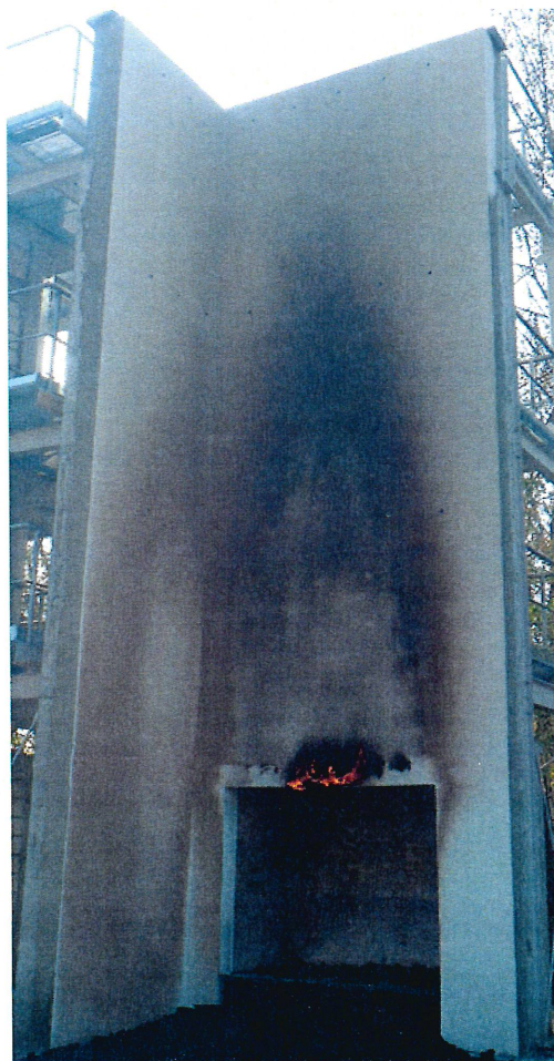
Fotografia 40. System po wygaszeniu źródła ognia
