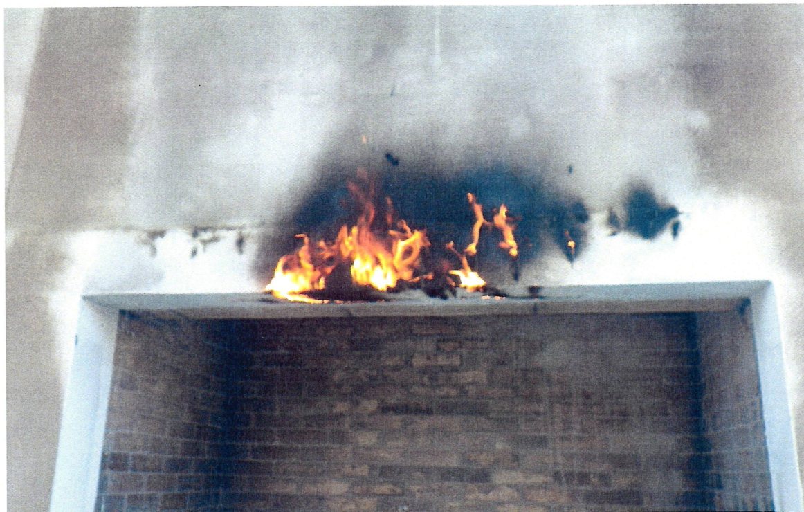
Fotografia 39. System po wygaszeniu źródła ognia
