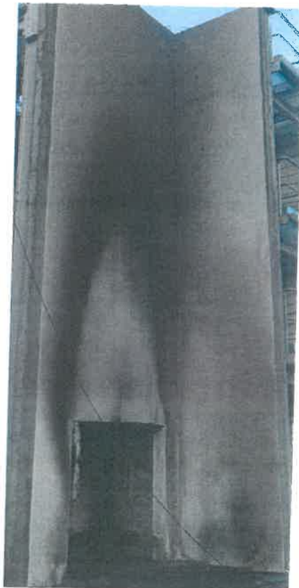
Fotografia 31. System w trakcie badania – po wygaszeniu źródła ognia
