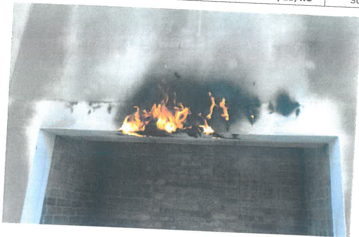
Fotografia 39. System po wygaszeniu źródła ognia
