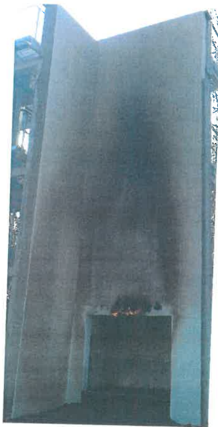
Fotografia 38. System w trakcie badania – po wygaszeniu źródła ognia
