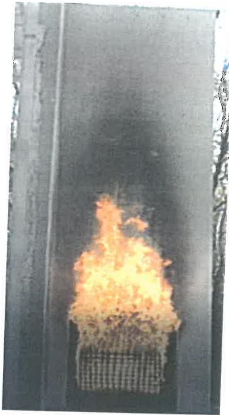
Fotografia 35. System w trakcie badania – 20 minuta badania
